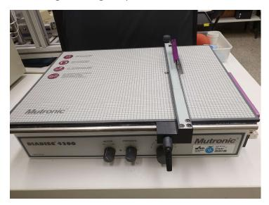
Schnitthöhe: 0 -14 mm stufenlos
